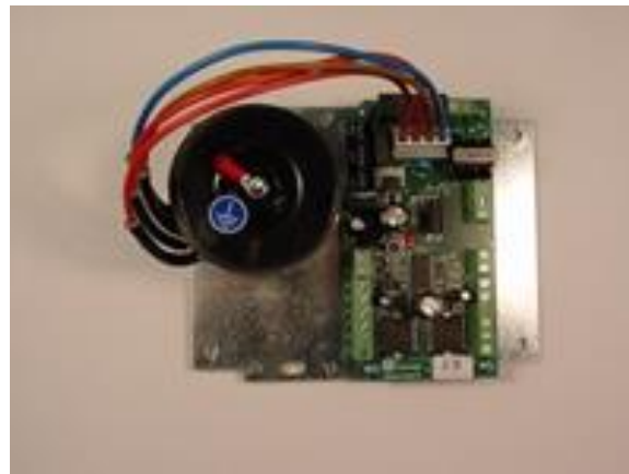
n. 1 Alimentatore (piastra con trasformatore 220/20V AC e scheda elettronica)
